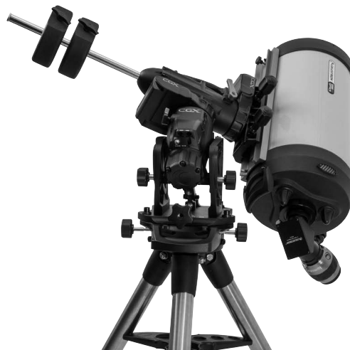
Figura 9.1 Un lato del limite meccanico di AR
